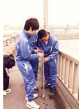
透視度計で にがり具合を 調べる
